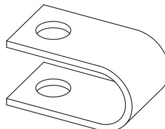
Figure 8 - U-Strap for round groove dies
